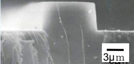
石英系ガラス材料を用いた 光導波路の電子顕微鏡写真
