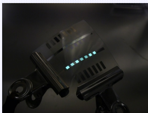
プラスチック上に作製した有機EL素子
